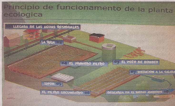
Esquema de cómo funciona la planta de depuración natural diseñada. / DB
